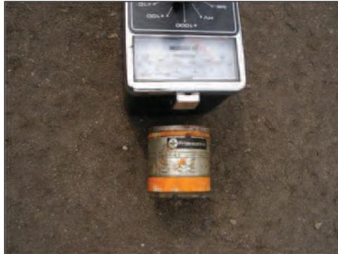
Abbildung 4-1: Strahlenfund im Mischschrott
